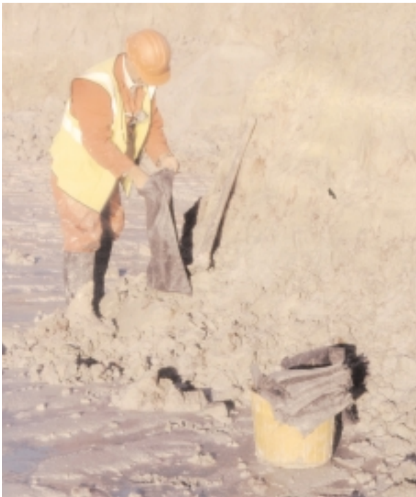
La collecte de différents échantillons d'argile fine au front de la carrière.
